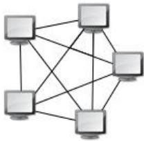
Le réseau maillé est une topologie de réseau qualifiant les réseaux dont les hôtes sont connectés entre eux sans hiérarchie centrale, forant ainsi une structure en forme de filet. Par conséquent, chaque nœud doit recevoir, envoyer et relayer les données. Cela évite d'avoir des points sensibles, qui en cas de panne, coupent la connexion d'une partie du réseau. Si un hôte est hors service, ses voisins passeront par une autre route.
