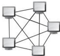
Le réseau maillé est une topologie de réseau qualifiant les réseaux dont les hôtes sont connectés entre eux sans hiérarchie centrale, formant ainsi une structure en forme de filet. Par conséquent, chaque nœud doit recevoir, envoyer et relayer les données. Cela évite d'avoir des points sensibles, qui en cas de panne, coupent la connexion d'une partie du réseau. Si un hôte est hors service, ses voisins passeront par une autre route.
